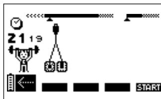
Прибор подает звуковой сигнал и поочередно отображает то символ пары электродов, то стрелку, указывающую канал, в котором обнаружена проблема. В примере, показанном выше, стимулятор обнаружил ошибку в канале 1.
